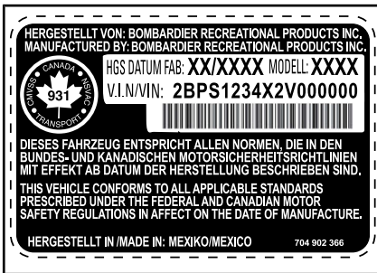
TYPISCH — HINWEISSCHILD MIT FAHRZEUGSERIENNUMMER UNTER HANDSCHUHFACH
