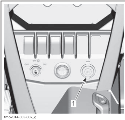
1. Электрическая розетка (12 В)
