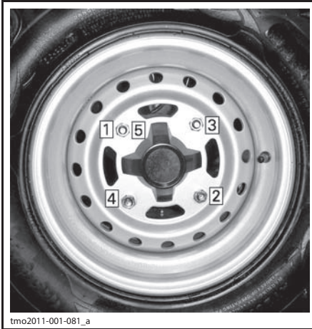
Последовательность затяжки
