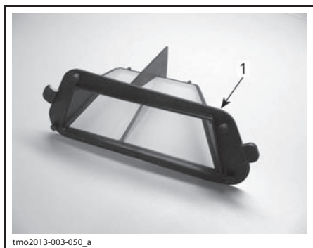
1. Воздушный фильтр вариатора
