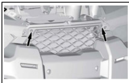
ZU ENTFERNENDE KUNSTSTOFFNIETEN
