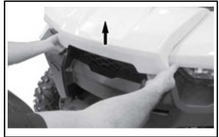
HOCHHEBEN DER WARTUNGSABDECKUNG.
