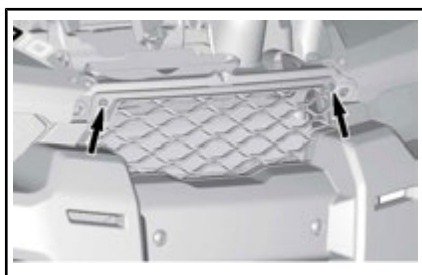
ZU ENTFERNENDE KUNSTSTOFFNIETEN
