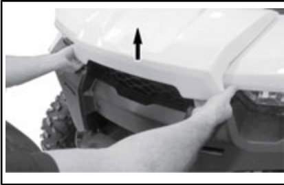
LEVANTANDO A BORDA DA TAMPA DE MANUTENÇÃO FRONTAL.
