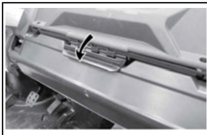
SBLOCCAGGIO DELLO SPORTELLO
