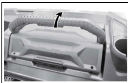
BLOCCO IN POSIZIONE DELLA CASSETTA DEGLI ATTREZZI
