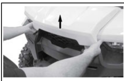
SOLLEVARE IL BORDO DEL COPERCHIO DI MANUTENZIONE ANTERIORE.
