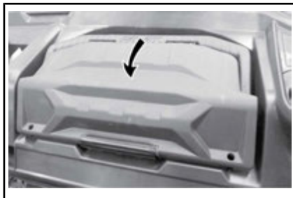
SBLOCCO DELLA CASSETTA DEGLI ATTREZZI ESTRAIBILE
