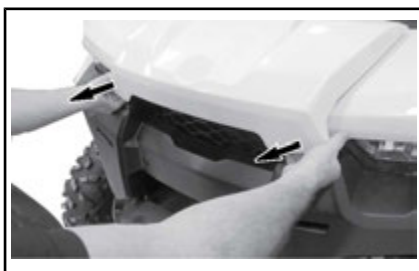
TIRARE IL BORDO DEL COPERCHIO DI MANUTENZIONE ANTERIORE.
