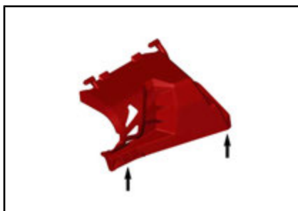
SOULEVEZ L'ARRIÈRE DU COUVERCLE D'ENTRETIEN
