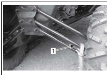
1. Bras de suspension central arrière
