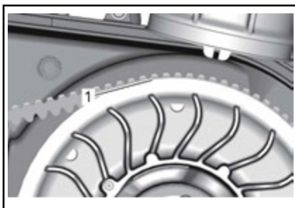
1. Partie la plus basse des pignons alignée avec la surface externe de la courroie d'entraînement
