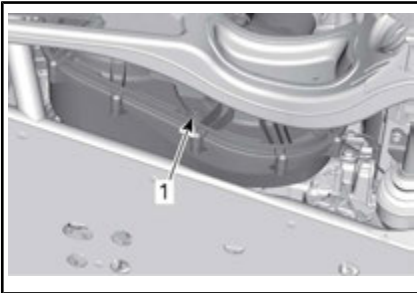
1. Drainage de la boîte de vitesses CVT
