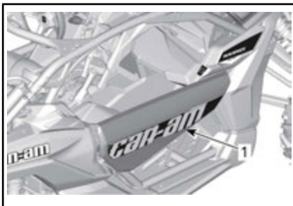
1. Porta fechada e corretamente travada
