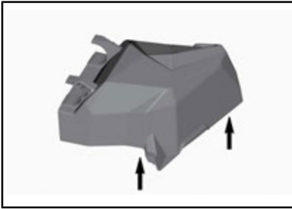
LEVANTAR A PARTE TRASEIRA DA TAMPA DE SERVIÇO
