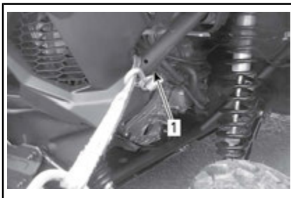
1. Gancho de reboque traseiro
