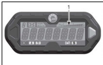
1. Visualización del nivel de combustible
