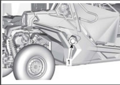
1. Tapón del depósito de combustible
