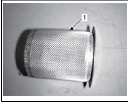
1. Limpieza del supresor de chispas
