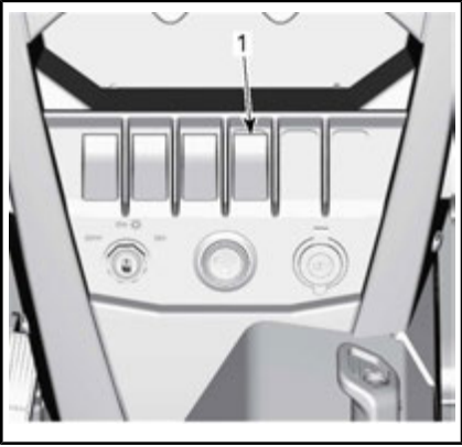
1. Interruptor de DPS
