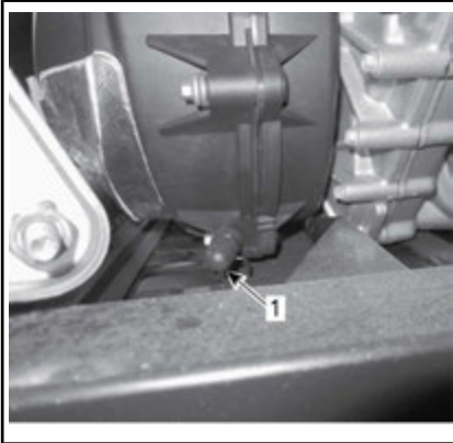
1. Drenaje de la CVT
