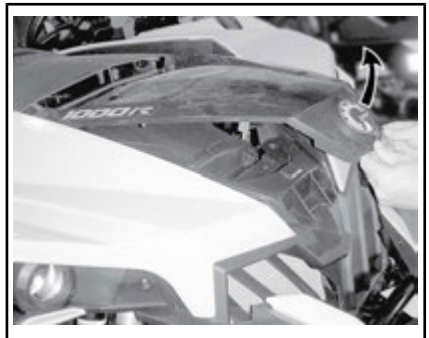
Etapa 2: Retire suavemente la sujeción de la cubierta de su arandela y a continuación libere la sujeción en el otro lado.
