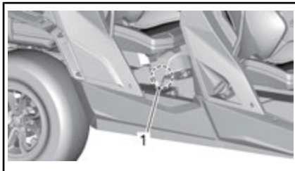
TYPIQUE - EMLACEMENT DES ÉLÉMENTS FUSIBLES ET DE LA BOÎTE À FUSIBLE 3 SUR LE VÉHICULE
