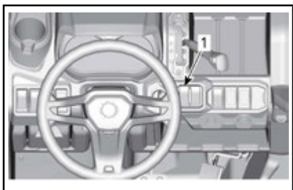
1. Interrupteur du différentiel avant/2/4 roues motrices
