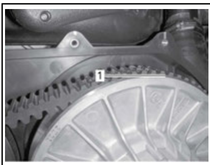
1. Partie la plus basse des pignons alignée avec la surface externe de la courroie d'entraînement
