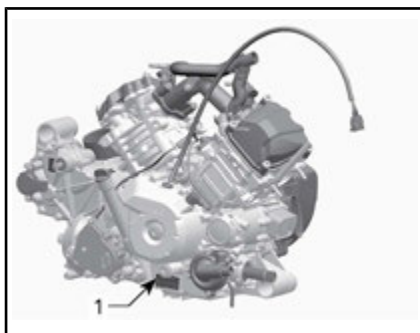
TÍPICO HD8 Y HD10 — ETIQUETA DE NÚMERO DE SERIE DEL MOTOR
