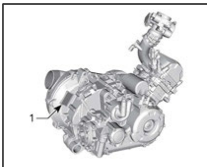
TÍPICO HD5 — ETIQUETA DE NÚMERO DE SERIE DEL MOTOR
