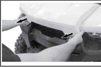
TIRER SUR LA BORDURE DU COUVERCLE D'ENTRETIEN AVANT.
