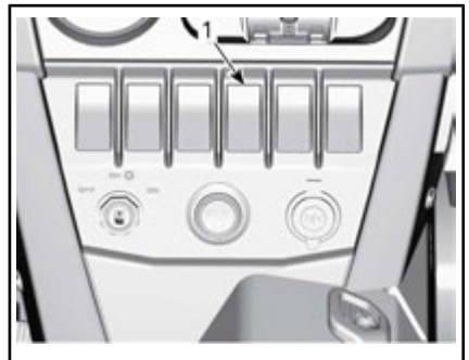
1. Interruptor de DPS
