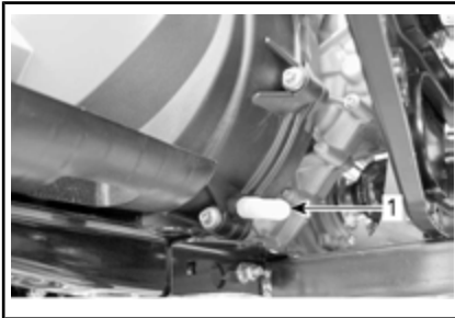
1. Drenaje de la CVT
