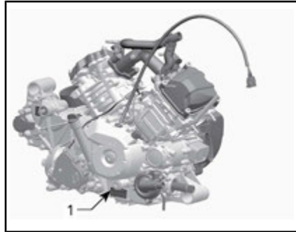
TYPISCH — HINWEISSCHILD MIT MOTOR-SERIENNUMMER
