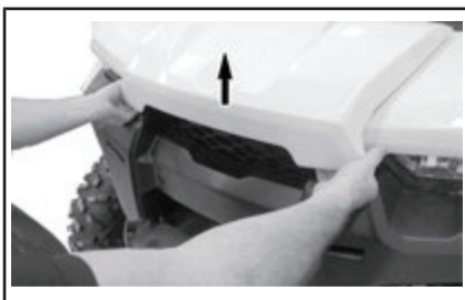
DE RAND VAN HET VOORSTE ONDERHOUDSDEKSEL OPTILLEN.
