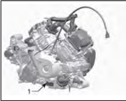
TYYPILLINEN — MOOTTORIN SARJANUMEROKILPI
