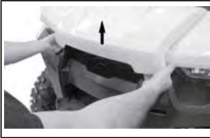
LEVANTAMIENTO DEL BORDE DE LA TAPA DE ACCESO DELANTERA.
