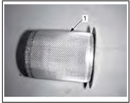
1. Limpieza del supresor de chispas
