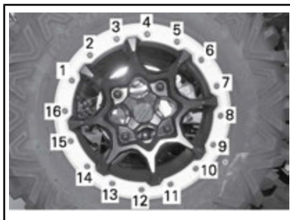
代表例 - 最後の締め付け順序
