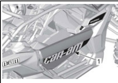
1. Puerta cerrada y correctamente bloqueada.
