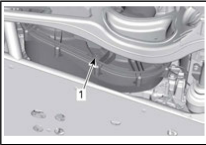
1. Drenaje de la CVT
