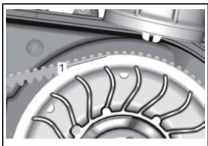
1. Parte inferior de los dientes a la altura de la superficie externa de la correa conductora
