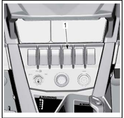
1. Interruptor de DPS
