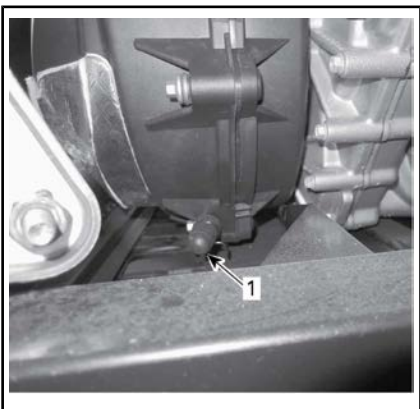
1. Drenaje de la CVT
