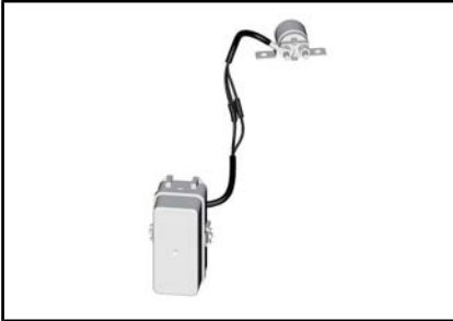
FUSIBILE COLLEGATO ALLA SCATOLA DI FUSIBILI
