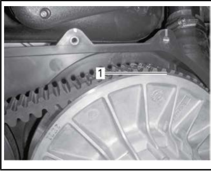
1. Porzione più bassa delle ruote dentate con la superficie esterna della cinghia di trasmissione
