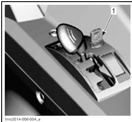
TYPIQUE - LE LEVIER SÉLECTEUR PEUT ÊTRE VERROUILLÉ À LA POSITION «P» 1. Clé de verrouillage du levier sélecteur
