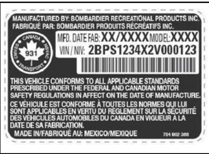
TYYPILLINEN — AJONEUVON SARJANUMEROKILPI HANSIKASLOKERON ALLA
