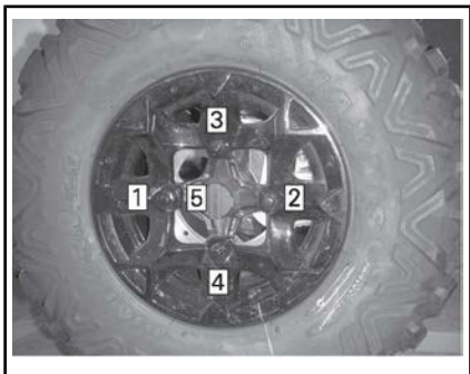
TYYPILLINEN KIRISTYSJÄRJESTYS
