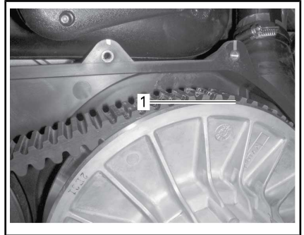
1. Unterster Teil der Zahnräder bündig mit der Außenfläche des Antriebsriemens
