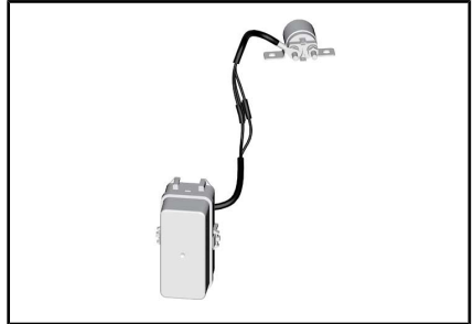
SCHMELZLOT VERBUNDEN MIT SICHERUNGSKASTEN
