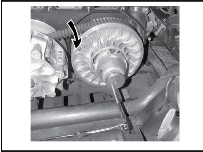
1. Unterster Teil der Zahnräder bündig mit der Außenfläche des Antriebsriemens
