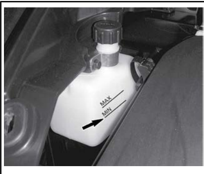
Típico - DEPÓSITO DE EXPANSIÓN DEL REFRIGERANTE
