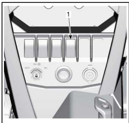
1. Interruptor de DPS
