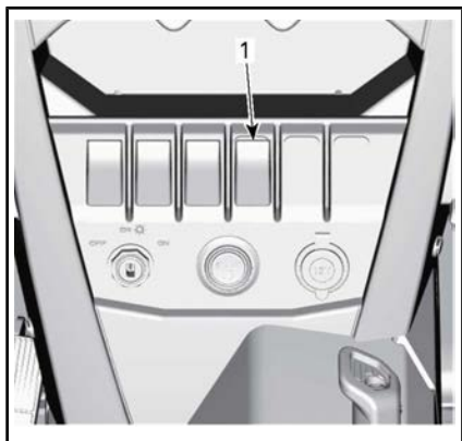
1. Interruptor de DPS
