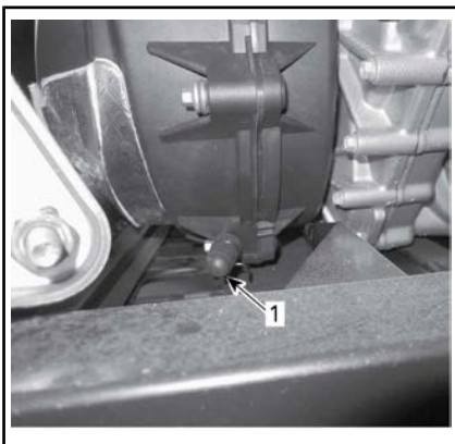
1. Drenaje de la CVT
