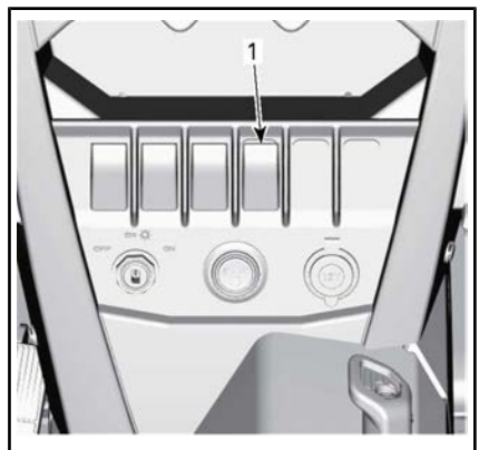
1. Interruptor de DPS
