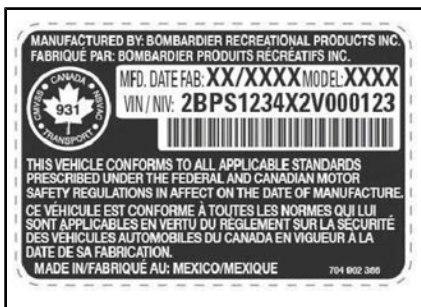
TYPISCH — HINWEISSCHILD MIT FAHRZEUGSERIENNUMMER UNTER HANDSCHUHFACH
