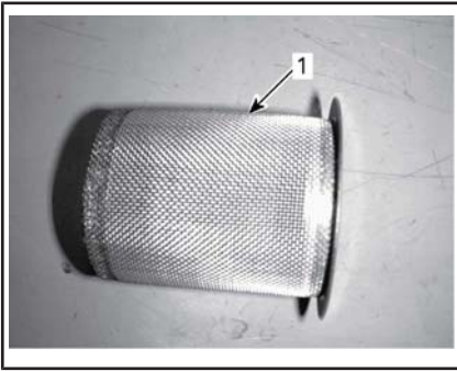
1. Limpieza del supresor de chispas
