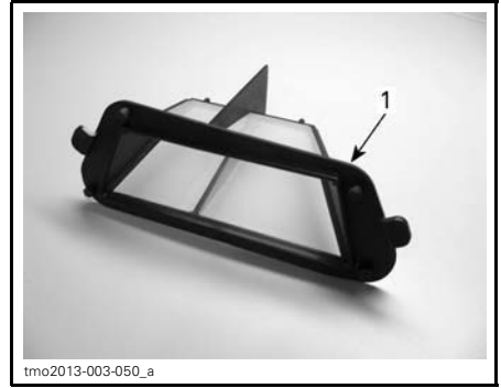
1. Filtre à air de la transmission CVC
