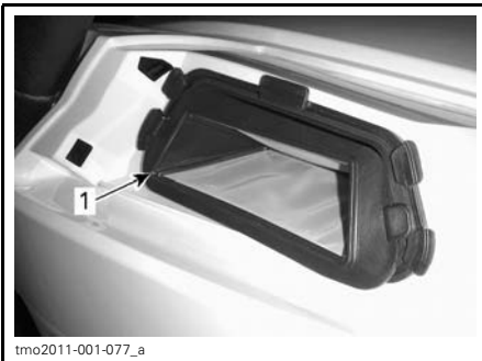
1. Filtre à air de la transmission CVC
