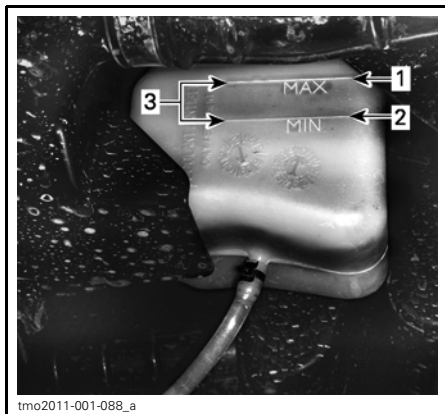
VASE D'EXPANSION DE LIQUIDE DE REFROIDISSEMENT
