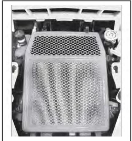
3. Compruebe que la tapa está bien colocada en el alojamiento del filtro de aire del motor antes de cerrar las sujeciones.
