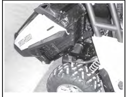
VORDERER BEREICH DER GENEIGTEN TRANSPORTBOX FREI VON GEGENSTÄNDEN
