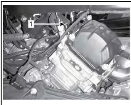
1. Entlüftungsschraube des hinteren Zylinders
