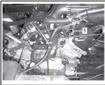
1. Entlüftungsschraube des vorderen Zylinders
