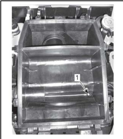
1. Orifício de drenagem
