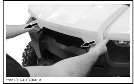
tmo2016-010-060_a TIRER SUR LES REBORDS DU COUVERCLE DE SERVICE AVANT
