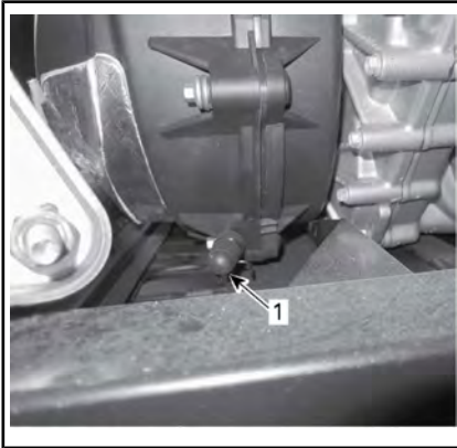
1. Drenagem da CVT
