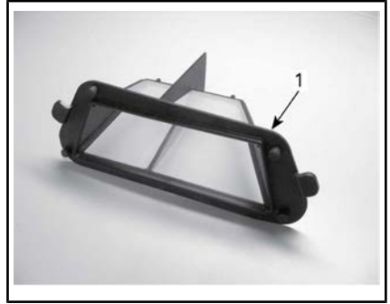
1. CVT:n (portaaton voimansiirto) ilmansuodatin
