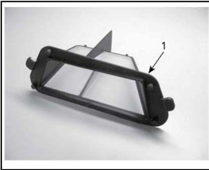
1. CVT:n (portaaton voimansiirto) ilmansuodatin
