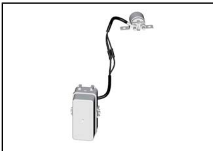
JOHTOSULAKE LIITETTY SULAKKEKOTELOON
