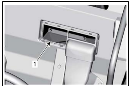
1. CVT:n (portaaton voimansiirto) takailmansuodatin
