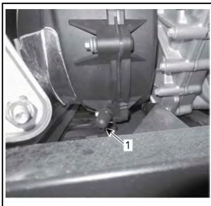
1. Drenagem da CVT
