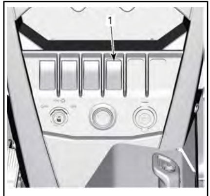
1. Interruptor de DPS
