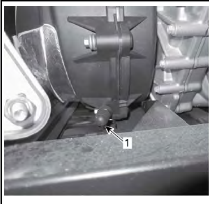
1. Drenaje de la CVT
