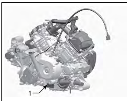
TÍPICA — ETIQUETA DO NÚMERO DE SÉRIE DO MOTOR
