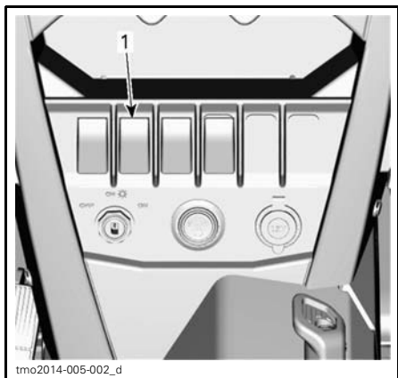
1. Sélecteur de mode 2 ou 4 roues motrices
