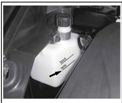
DEPÓSITO DE EXPANSIÓN DEL REFRIGERANTE
