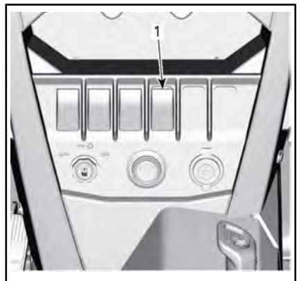
1. Interruptor de DPS
