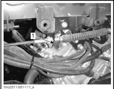
LH SIDE — FRONT CYLINDER 1. Spark plug
