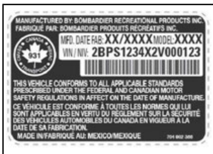
TYPISCH - ETIKET MET SERIENUMMER VOERTUIG ONDER HANDSCHOENVAK
