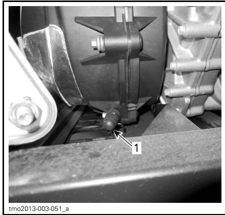
1. Drain de la transmission CVC
