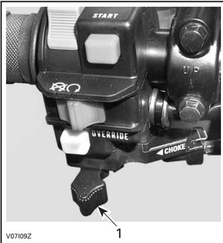
1. Choke in vollständig geöffneter Position
