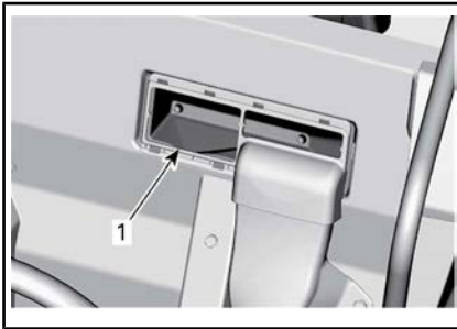
1. Filtro dell'aria CVT posteriore
