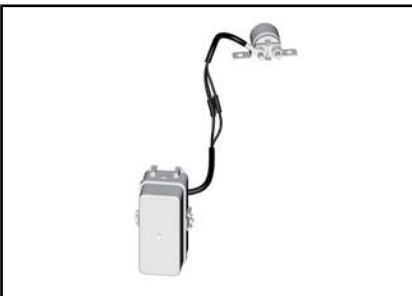
FUSIBILE COLLEGATO ALLA SCATOLA DI FUSIBILI
