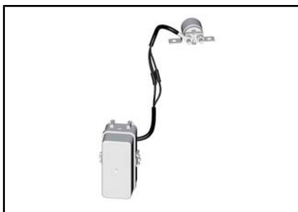
JOHTOSULAKE LIITETTY SULAKEKOTELOON
