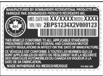
TYYPILLINEN — AJONEUVON SARJANUMEROKILPI HANSIKASLOKERON ALLA
